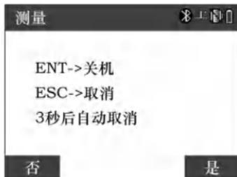
按【ENT】键即关闭仪器电源，按【ESC】退出该提示框，三秒钟内没有按键则自动退出该提示框。
