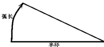
圆曲线包括半径和弧长。半径值的规定为：沿着曲线前进的方向。当向右转弯时半径为正值，当向左转弯时半径为负值。弧长不能为负数。
