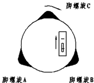
③再次旋转仪器  $90^\circ$ ，重复步骤①、②，直到四个位置上气泡居中为止。
