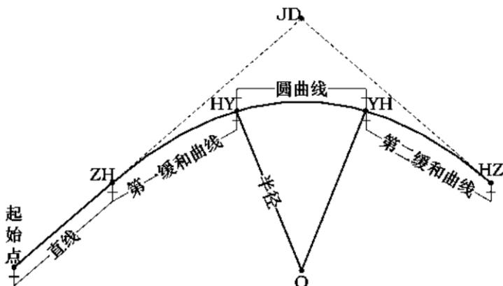
缓和曲线包括最小半径和弧长。其半径正负的规定和圆半径的正负的规定一样。同样，弧长也不能为负数。
