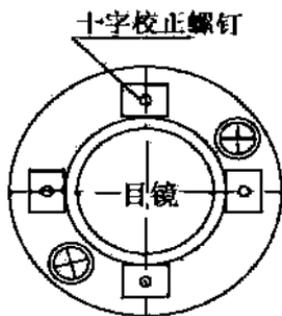
**注意：**校正后应检查光电同轴性。
