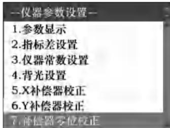
补偿器零位校正之前请务必确认，关闭补偿器，且指标差极小。如需校正指标差，请参照指标差校正步骤。
