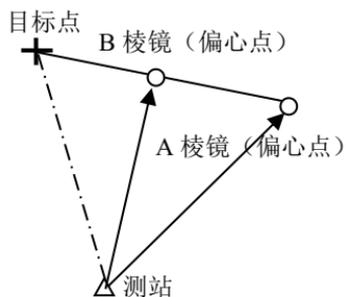
•将偏心点 A 和 B 设在由目标点引出的直线上，通过对偏心点 A、B 的测量，并输入 B 点与目标间的距离来定出目标点。
