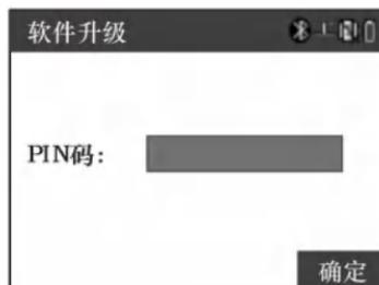
1. 输入 PIN 码（82543）之后按【ENT】键，仪器关机；
