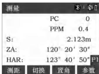
在基本测量屏幕下按【ESC】键返回到初始屏幕，可以进入内存和配置操作功能屏幕。
